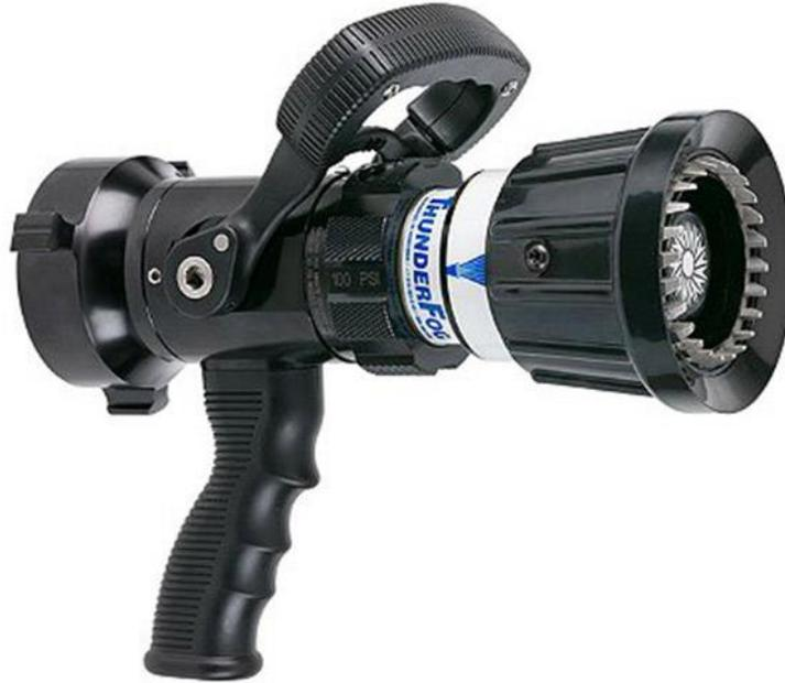
La boquilla Thunderfog de caudal seleccionable con cinco ajustes de 95, 125, 150, 200 y 250 gpm @ 100 psi (360-470-570-750-950 l/min @ 7 bar). Construida con materiales ligeros, aluminio anodizado duro. Flush sin necesidad de cerrar. Con dientes de acero inoxidable giratorios o Dientes troquelados opcionales. Válvula de bola para cierre de acero inoxidable. Mango de pistola montado debajo de la válvula. Acoplamiento NH de 2.5" es estándar.
