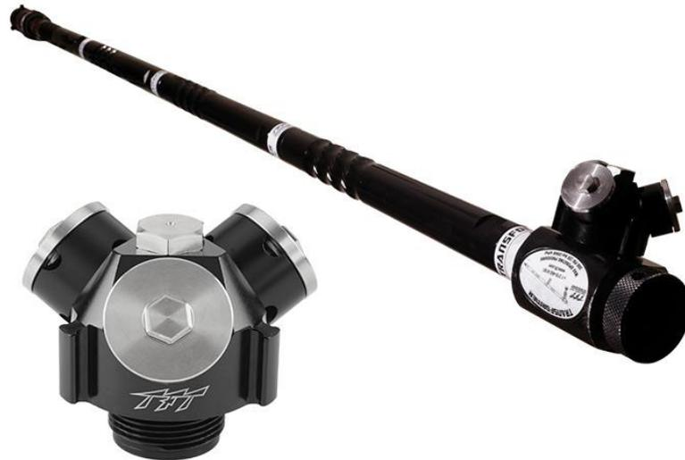
El KIT Transformer PA3-EV está diseñado para facilitar la aplicación de agua en la parte inferior de un vehículo eléctrico. Cada kit incluye cuatro tubos de extensión de 19" (0,5 m) y una boquilla distribuidora (bodega) con un patrón amplio y completamente lleno que permite que el agua se distribuya a través del compartimiento de la batería para un enfriamiento efectivo.
